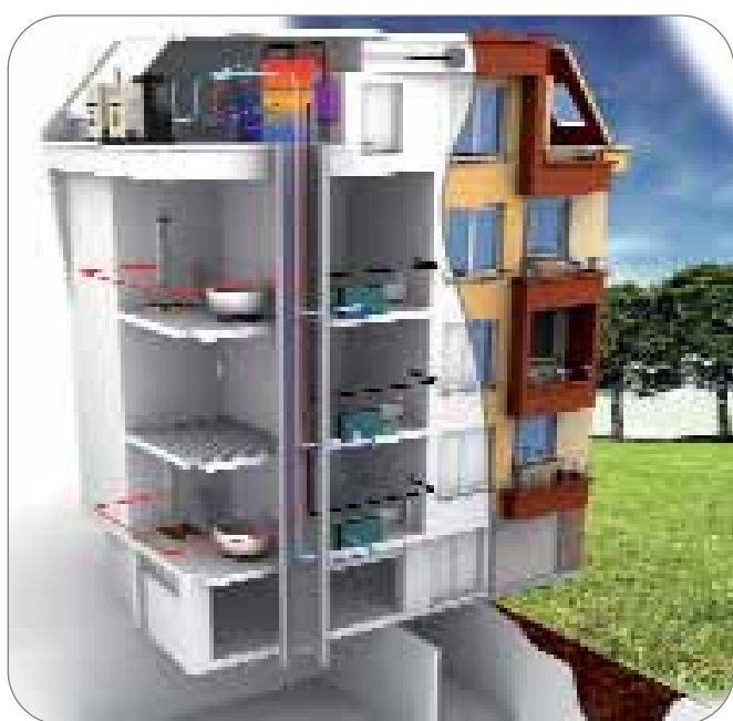
Esempio di applicazione GA-HR con pompa di calore reversibile GAHP-AR in funzionamento estivo per fancoils e produzione indiretta ACS.
